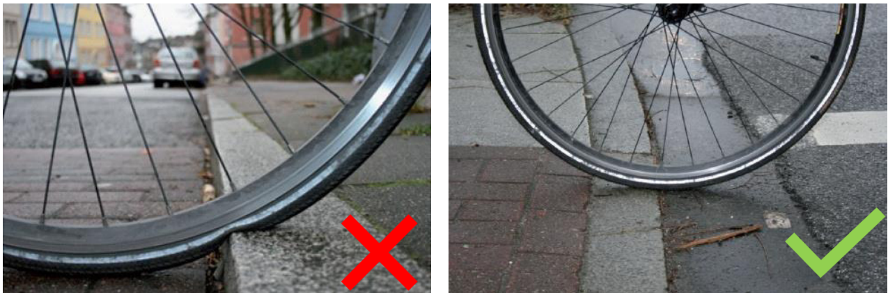
Obrázek 25 Působení obrubníku na kolo bicyklu (zdroj: cyklodoprava.cz)
